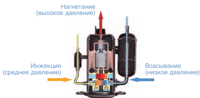
Двухступенчатый DC-инверторный компрессор
