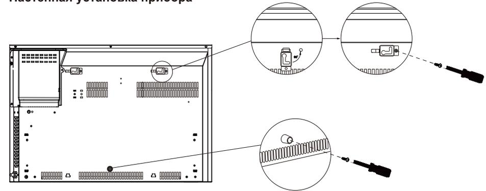
1. Вставьте скобы (в специально отведенные отверстия), поверните их против часовой стрелки на 90 градусов и закрепите их винтом.
